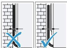
Μη μαγκώσετε τους εύκαμπτους σωλήνες και το καλώδιο σύνδεσης στο δίκτυο του ρεύματος μεταξύ του τοίχου και της συσκευής.
