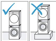
Τοποθετήστε αυτή τη συσκευή μόνο με το γνήσιο σετ σύνδεσης του κατασκευαστή του στεγνωτήρα σε μια στήλη πλυντηρίου-στεγνωτηρίου.
