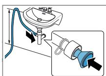
Ασφαλίστε το σημείο σύνδεσης με έναν σφιγκτήρα εύκαμπτου σωλήνα (12-22 mm). Στερεώστε τον εύκαμπτο σωλήνα της αποχέτευσης
