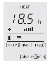
Εικόνα 2, Χρονοδιακόπτης απενεργοποίησης όταν η συσκευή είναι σε λειτουργία
