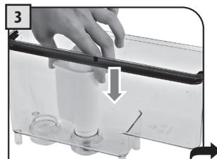
Insérer le filtre dans son logement à l'intérieur du réservoir vide (voir figure). Appuyer jusqu'au point d'arrêt.
