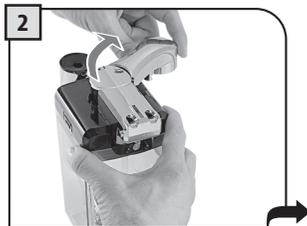
2 Tourner la poignée dans le sens des aiguilles d'une montre pour la débloquer.
