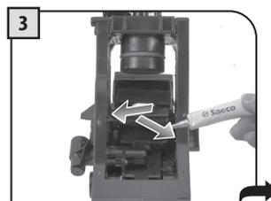
Ne lubrifier les convoyeurs du groupe qu'avec la graisse fournie.
