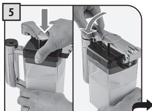
5 Remettre le couvercle en vérifiant qu'il soit bien fermé. Remettre la poignée dans la position centrale pour assurer une fermeture parfaite.
