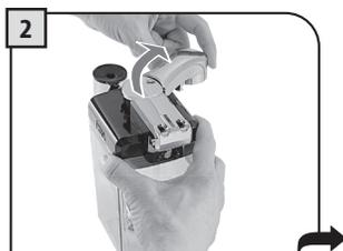
2 Décrocher la poignée en la tournant dans le sens des aiguilles d'une montre.
