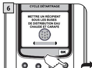
Placer un récipient au-dessous de la buse de distribution du café et un récipient sous la buse de distribution de l'eau chaude. Appuyer ensuite sur la touche « OK ».
