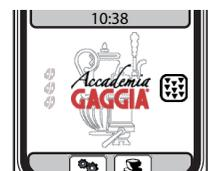
La machine nécessite un cycle de détartrage.
