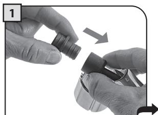
1 Insérer le raccord interne dans le tuyau et le pousser jusqu'au fond.
