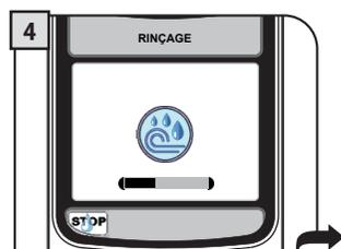
Une fois la phase de chauffage terminée, la machine effectue un cycle de rinçage des circuits internes. Pour arrêter le cycle, appuyer sur la touche « STOP ».
