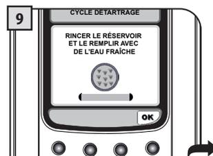
À la fin de la première phase, une fois terminé le détartrant, la machine demande le rinçage du réservoir.
