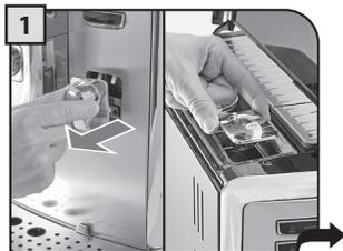
1 Enlever le carter de protection de la machine et le garder dans un endroit propre. On recommande de l'introduire dans le logement du couvercle à eau.
