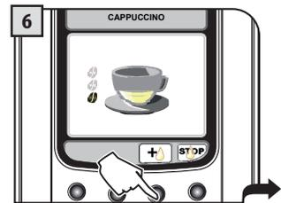
6 La distribution de lait peut être augmentée en appuyant sur la touche « + » ; dans ce cas, le lait distribué n'est PAS émulsionné.
