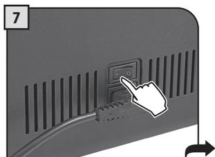
7 Appuyer sur l'interrupteur général et le mettre sur la position « 1 ».
