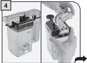
4 La carafe doit être enlevée de la machine et ensuite vidée. Décrocher la poignée en la tournant dans le sens des aiguilles d'une montre.
