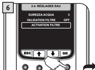
Accéder au « MENU MACHINE » (voir page 25). Sélectionner « RÉGLAGES EAU » et « ACTIVATION FILTRE », appuyer ensuite sur « OK ».
