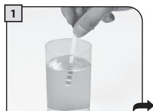
Plonger dans l'eau la bande de test fournie avec la machine pendant une seconde, afin de vérifier la dureté de l'eau.
