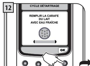
Vider complètement la carafe (page 36 - fig.7) et la remplir d'eau fraîche potable. Introduire la carafe et la positionner en position de distribution. Appuyer ensuite sur la touche « OK ».
