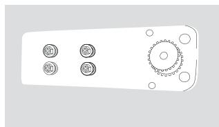
Scoateți șuruburile și piciorul reglabil din partea opusă și fixați-le înapoi unde au fost pe suportul balamalei.
