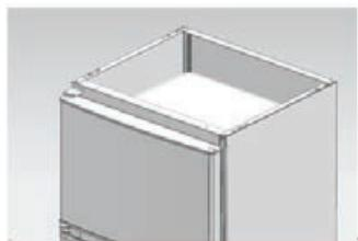
11. Instalați ușa și balamaua cu suruburi.
