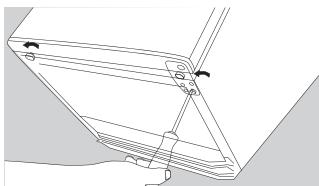
5. Desfaceți șuruburile și scoateți suportul balamalei din bază. O cheie poate fi necesară pentru a slăbi șuruburile. Scoateți balama și re-poziționați-o în locația pe partea opusă
