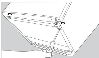
5. Ξεβιδώστε τις βίδες και αφαιρέστε τον βραχίωνα του μεντεσέ από τη βάση. Μπορεί να χρειαστεί γαλλικό κλειδί για να χαλαρώσετε τις βίδες. Αφαιρέστε την ακίδα του μεντεσέ και τοποθετήστε την στην απέναντι πλευρά.
