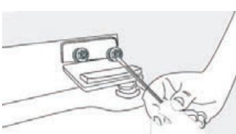
2. Scoateți cele 2 șuruburi fixate pe balama
