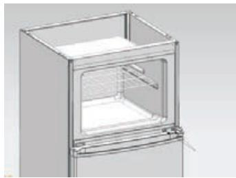
4. Deșurubați balama ușă fixă, scoateți ușă.
