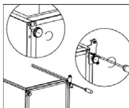
12. Στερεώστε τη συσκευή και τοποθετήστε την πόρτα στον κάτω μεντεσέ. Βεβαιωθείτε ότι το κάλυμμα του κάτω μεντεσέ έχει τοποθετηθεί στην πόρτα. Μετακινήστε το κάλυμμα του κάτω μεντεσέ της πόρτας από την αριστερή στη δεξιά μεριά.
