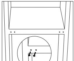
7. Τοποθετήστε τη συσκευή με κλίση προς τα πίσω σε μια μαλακή επιφάνεια. Ξεβιδώστε τον κάτω μεντεσέ και το πόδι.
