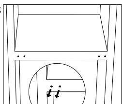
11. Τοποθετήστε τη συσκευή με μια κλίση προς τα πίσω σε μια μαλακή επιφάνεια. Ξεβιδώστε τον κάτω μεντεσέ και το πόδι.
