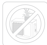
Βεβαιωθείτε ότι δεν υπάρχει κανένα εμπόδιο σε όλες τις εισόδους και τις εξόδους αέρα
