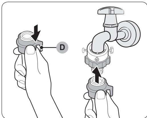
6. Ενώ τραβάτε προς τα κάτω το **τμήμα (D)** στον σωλήνα νερού, συνδέστε τον σωλήνα νερού με τον σύνδεσμο. Στη συνέχεια, αφήστε το **τμήμα (D)**. Ο σωλήνας εφαρμόζει στον σύνδεσμο με έναν χαρακτηριστικό ήχο «κλικ».
