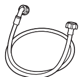
Crevo za dovod hladne vode
